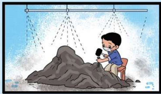
ลดการฟุ้งกระจายฝุ่น เช่น การใช้สเปรย์น้ำหรือพรมน้ำลวงวัตถุที่ตัดแต่งให้ชุ่มก่อนขณะตัด
